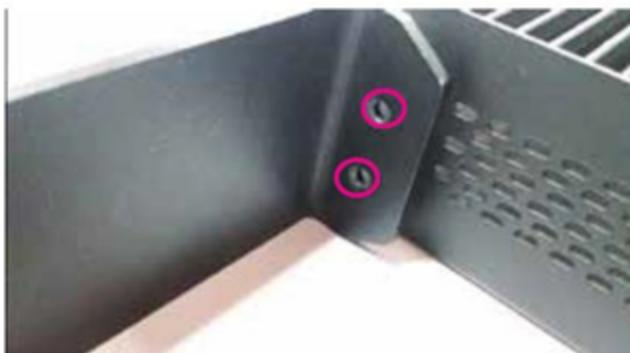
2. 在每侧插入两颗螺钉, 然后使用螺丝刀将其固定到位。
