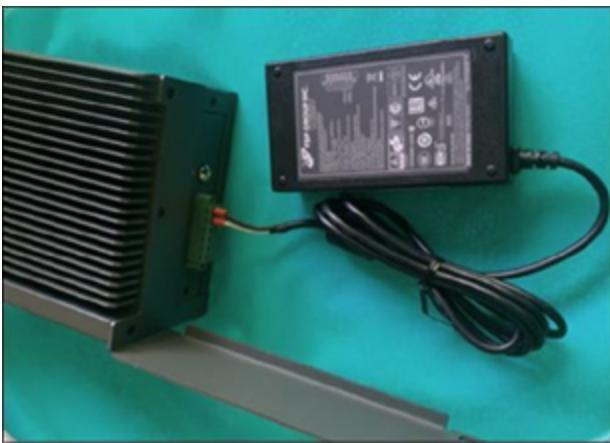
然后，将交流电源线(已提供)插入电源装置，并将另一端插入交流电源插座。
