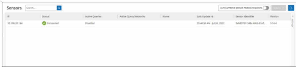
2. 如果要启用自动批准传感器配对请求，请确保将屏幕顶部的“自动批准传入的传感器配对请求”开关切换为“打开”。否则，所有配对请求都需要手动批准。
